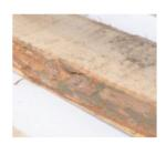
**Не допускается:** значительные сколы по внешнему контуру, обнаженные гвозди, выступающие гвозди, любые загрязнения на видимых частях поддона с резким запахом, наклейки, стрейч-пленка, частично повернутые шашки.
